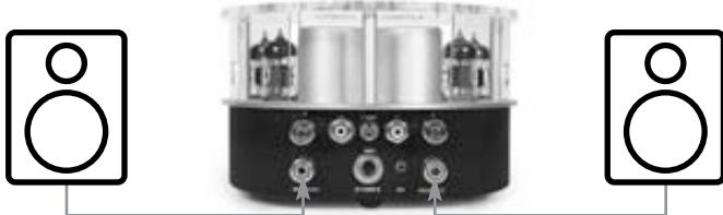
Collegare l'amplificatore ai diffusori tramite i cavi forniti in dotazione, assicurandosi di rispettare sia la giusta polarità (positivo e negativo), che il canale sinistro e destro. Assicurarsi che i diffusori abbiano un'impedenza superiore a 8 ohm, altrimenti si potrebbe danneggiare l'amplificatore.
