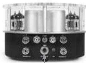
Inserire il cavo di alimentazione proveniente dall'alimentatore, nella presa posteriore dell'amplificatore. Selezionare la tensione di alimentazione (110V o 230V) sull'alimentatore, in accordo con quella fornita nella vostra nazione. Collegare il cordone di alimentazione nell'alimentatore e inserire la spina nella presa di tensione a muro.
