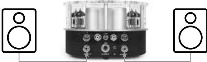
Den Verstärker mit den beigefügten Audiokabeln an die Lautsprecher anschließen und dabei sicherstellen, dass rechter und linker Kanal korrekt besetzt sind. Lautsprecher mit einer Impedanz über 8 Ohm wählen, da ansonsten das Verstärkersystem beschädigt werden könnte.
