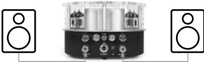
Conecte el amplificador a los altavoces con los cables provistos a tal fin, y asegúrese de que los canales derecho (R) e izquierdo (L) estén conectados correctamente. Seleccione una impedancia superior a 8 ohmios para los altavoces, puesto que de no ser así podría dañar el sistema amplificador.
