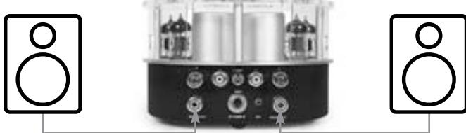
Sluit de versterker met de meegeleverde geluidsbron snoeren aan op de luidsprekers, waarbij u ervoor zorgt dat de L en R verbindingen juist tot stand worden gebracht. Kies luidsprekers met een impedantie die groter is dan 8 ohm, anders beschadigt u het systeem.
