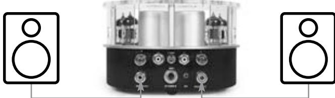
Forsterkeren kobles til høyttalerne med de vedlagte lydkablene. Pass på at høyre og venstre tilkobling er korrekt. For å unngå skade på forsterkersystemet må du ha høyttalere med impedans over 8 ohm.
